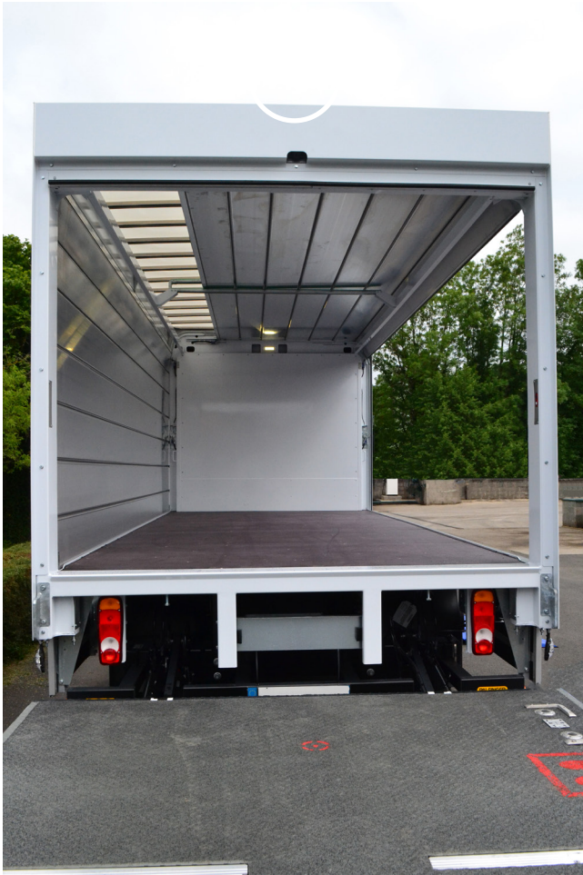
Chowane rolety boczne pod dachem
